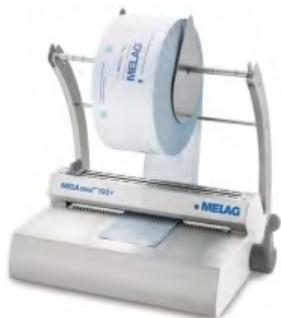
Termosigillatrice Melaseal 100+ completa di portarotoli verticale. Preriscaldamento 2 min. Larghezza dei bordi sigillati: 10 mm
