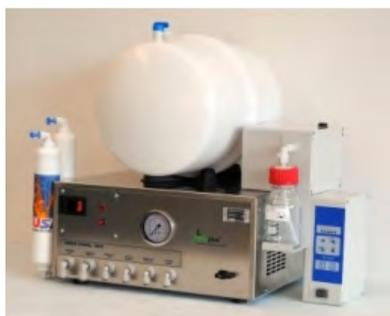
Sistema ad osmosi per la disinfezione delle acque, con biossido di cloro.
